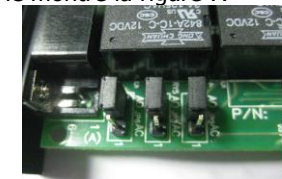
Fig. 7 - Position du cavalier en état ACTIF OUVERT
