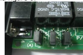
Fig. 6 - Position du cavalier en état ACTIF FERMÉ
