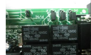
Fig. 5 - Marquage par sérigraphie de AO et AC indiquant les états des connecteurs 3 broches
