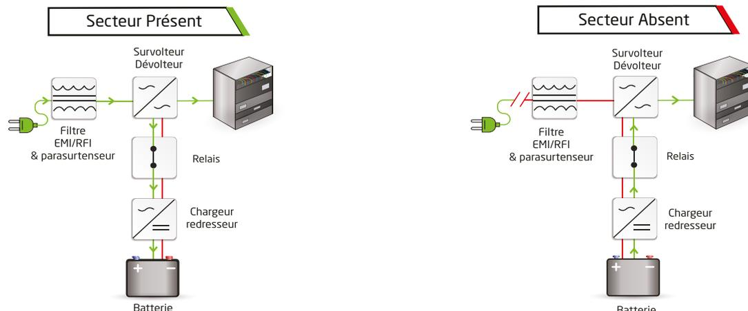
La technologie On Line Performance offre un niveau de protection proche de la technologie On Line Double Conversion. La tension délivrée est automatiquement régulée pour fournir un signal sinusoïdal parfait, que l'onduleur soit en mode secteur ou en mode batterie.
